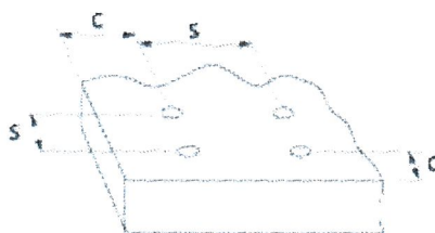
Rysunek B2. Parametry rozmieszczenia łączników PZ 3 i TX 30 w podłożu
