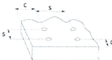
Rysunek B2. Parametry rozmieszczenia łączników PZ 3 i TX 30 w podłożu
